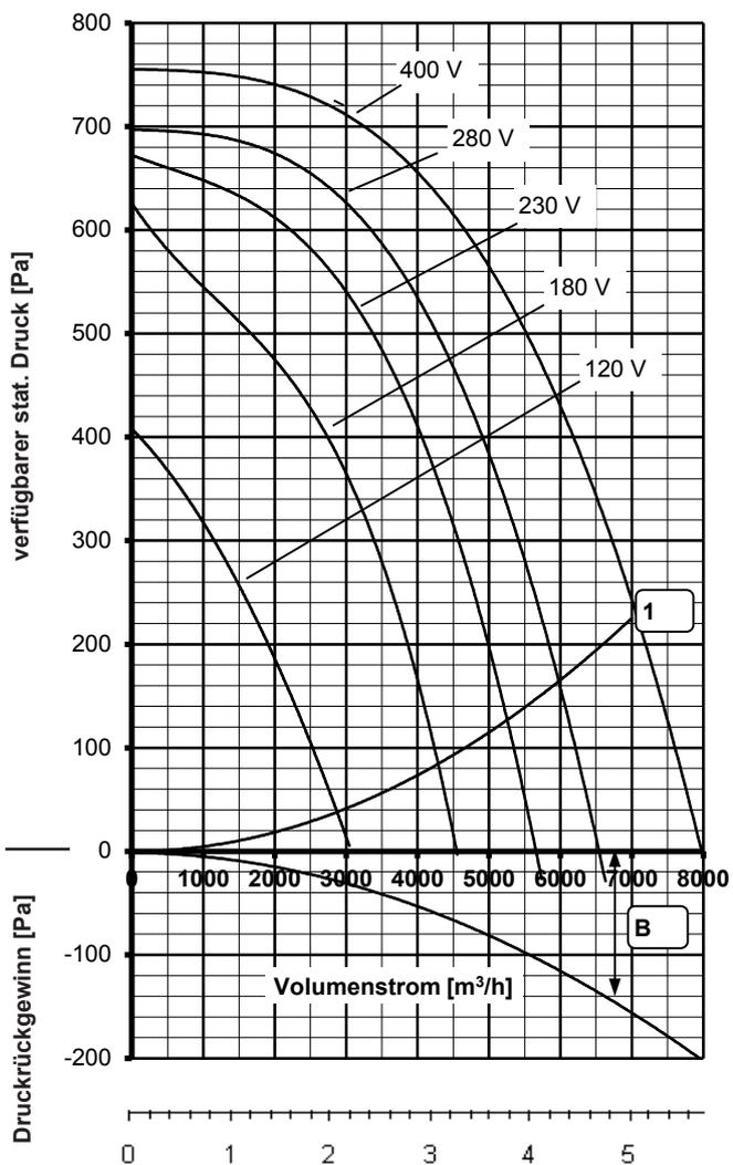
Diagramm und Tabelle berücksichtigen bereits sämtliche Verluste durch den Einbau des Ventilators in das Gehäuse. Die techn. Daten gelten für das Ventilatormodul als Abluftgerät oder im Zuluftgerät.
