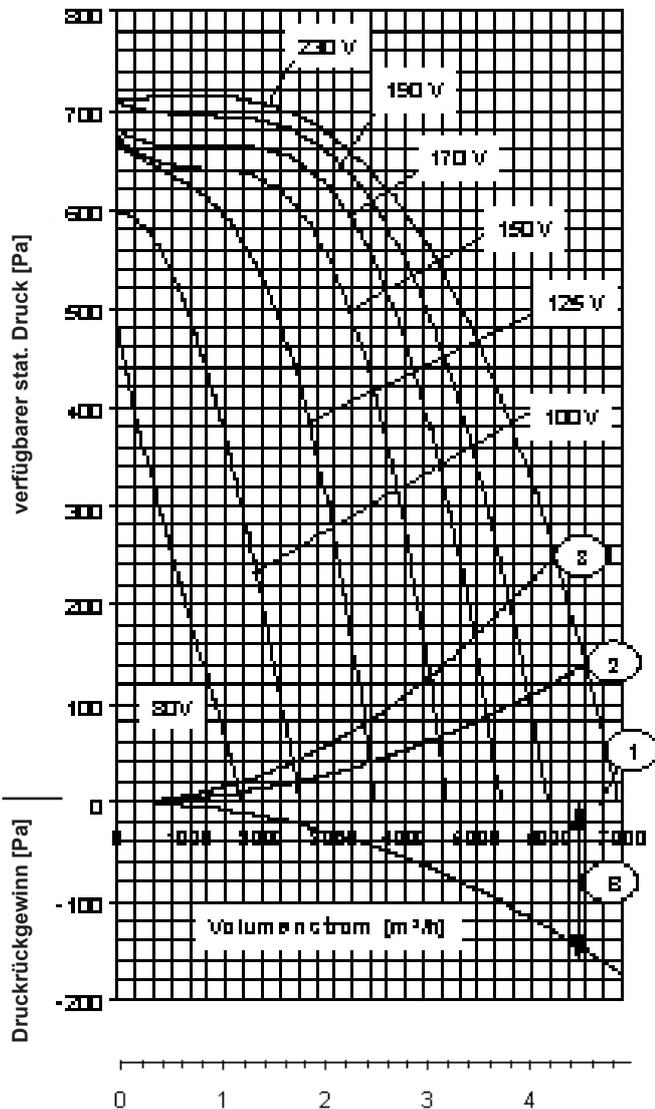
mittlere Ausblas-Strömungsgeschwindigkeit  $\bar{v}$  [m/s] bezogen auf das Ausblasanschlußmaß A
